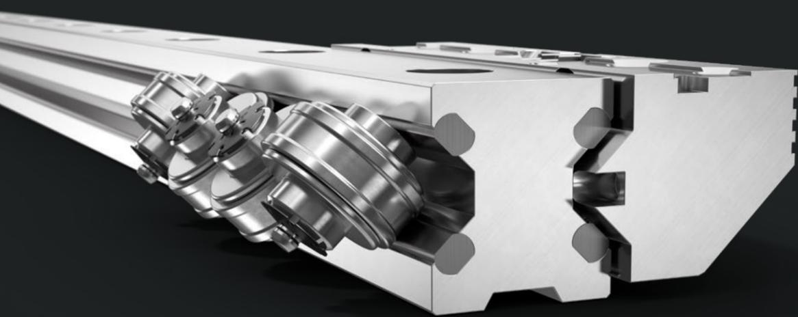
Franke Linearführungen sind die erste Wahl, wenn höchste Dynamik gefragt ist. Die großen Rollen sind sehr leichtgängig gelagert. Sie laufen reibungsarm und präzise geführt auf den eingelegten zäharten Stahlrähnen. Weil für die gesamte Konstruktion fast ausschließlich leichtes Aluminium verwendet wird, ist die bewegte Masse gering. Das Ergebnis: Höchste Dynamik und Energieeffizienz.
