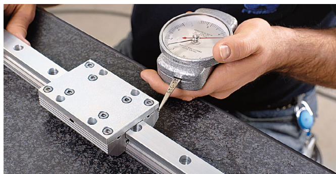
Abb. 3 Messen des Schiebewiderstandes
