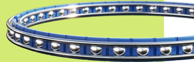
Der entscheidende Unterschied zwischen einem gewöhnlichen Kugellager und einem Franke Drahtwälzlager liegt in den Laufringen. Beim Drahtwälzlager rollen die Wälzkörper nicht auf massiven Gehäuseringen, sondern auf filigranen Drähten. Die Flexibilität des Franke-Prinzip erlaubt es, freier und einfacher zu konstruieren, um bessere Produkte zu entwickeln.
