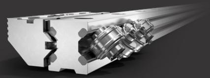
Franke Aluminium-Linearsysteme besitzen Grundkörper aus hochfestem, eloxiertem Aluminium. Die je nach Typ nadel- oder kugelgelagerten Laufrollen bestehen aus Wälzlerstahl. Stirnplatten aus Kunststoff beherbergen Filzabstreifer, die das Führungssystem sauberhalten.
